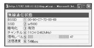
① BSSID ..... 無線アクセスポイントの「BSSID]を表示します。
